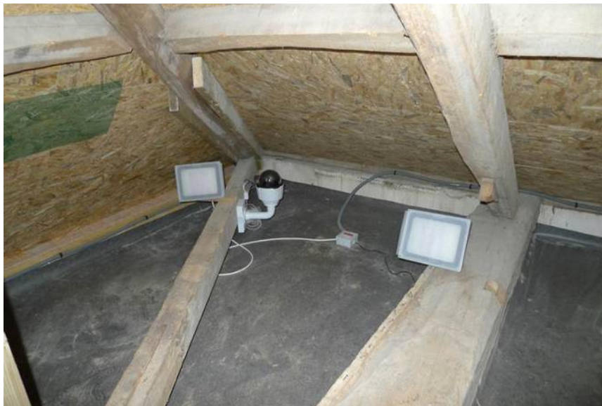
Figure 9 : Caméra 2 située dans la pièce isolée et alimentée par 2 projecteurs infrarouge.
